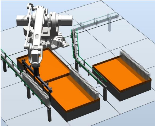
Флаконы разного объема (100, 250, 500, 1000 мл) поступают с двух линий для укладки их в лотки для последующей стерилизации.
