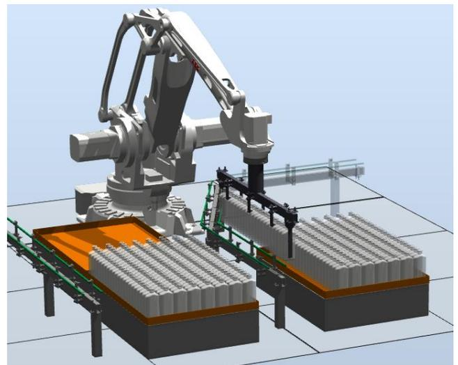
Обратный процесс происходит при выемке флаконов их лотков после стерилизации.
