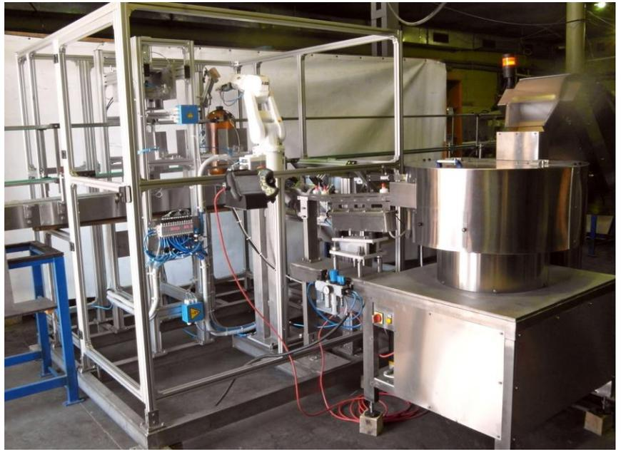
Данная роботизированная ячейка предназначена для сборки PET-кега при розливе пива. Трубка и фитинг запрессовываются в пластиковый кег, после чего он наполняется в автоматическом режиме углекислым газом.
