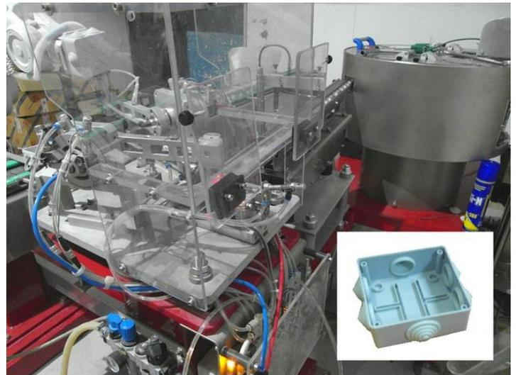
Данная роботизированная ячейка предназначена для вставки резиновых уплотнений в пластиковую распаечную коробку.
