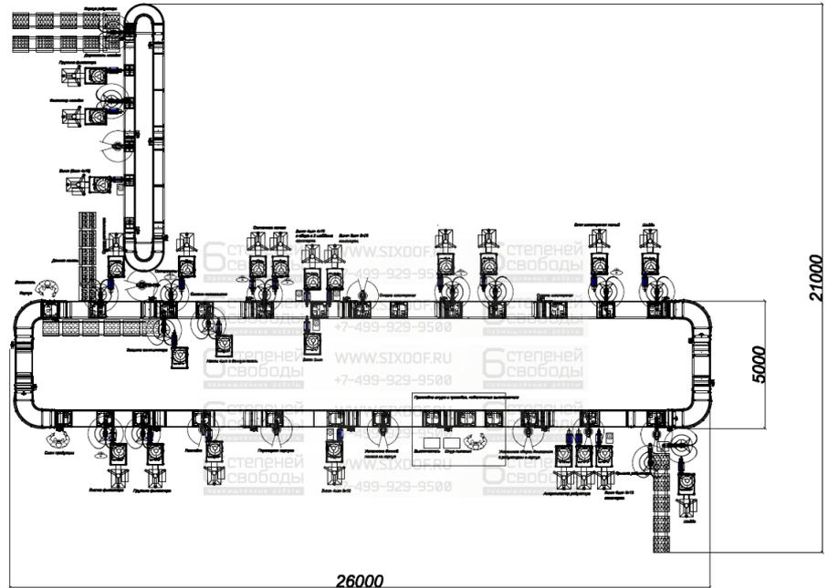
Данная сборочная линия предназначена для автоматической сборки бытовых мясорубок из деталей и готовых узлов при частичном участии операторов-сборщиков. Детали и узлы подаются навалом и ориентированными на поддонах.
