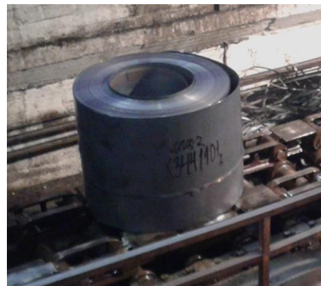
Последний виток может неплотно прилегать
